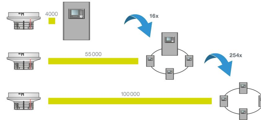
Extensión sencilla: SecuriLan conecta en red hasta 16 centrales a 55 000 detectores de incendios, formando un sistema global de altas prestaciones, SecuriWan hasta 254 redes SecuriLAN y 100 000 detectores de incendios en total.
