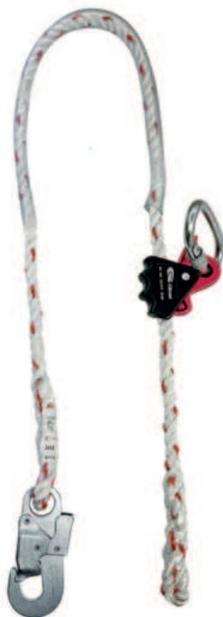
Elemento de amarre de sujeción regulable para trabajos de posicionamiento. Fabricado en cuerda de poliamida torcida de 14 mm con testigo de desgaste.
