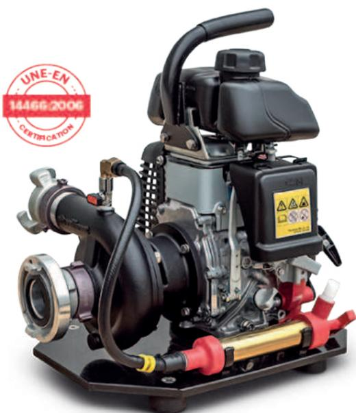
Motobomba compacta y eficiente, ideal para maniobras de ataque directo, autoprotección con aspersores y bombeo en tándem. Equipada con una bomba centrífuga de 1 etapa y un motor Honda de 4 tiempos, ofrece un rendimiento óptimo en operaciones forestales.
