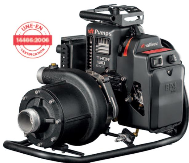
Motobomba ligera y potente diseñada para la extinción de incendios forestales. Equipada con una bomba centrífuga de 4 etapas y un motor de 2 tiempos Polini Thor 130 Evo de 10 HP, ofrece gran caudal y presión en largas distancias. Su diseño portátil (22 kg en seco) permite fácil transporte y operación intuitiva con panel LED y tacómetro.
