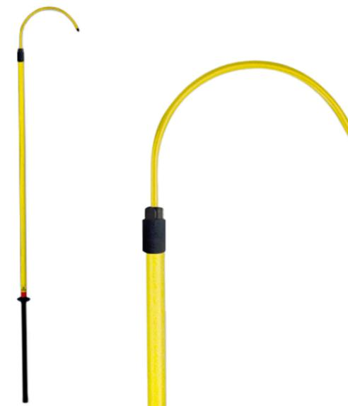
Fabricada en tubo de poliéster y fibra de vidrio de Ø 32 mm dotada de obturaciones antihumedad en ambos extremos, guardamanos, empuñadura, contera, cabezal métrico M-10 y gancho de salvamento.
