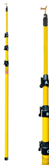
Pértiga telescópica de múltiples tramos fabricada en tubo de poliéster reforzado con fibra de vidrio de sección circular variable que permite trabar cada tramo automáticamente.
