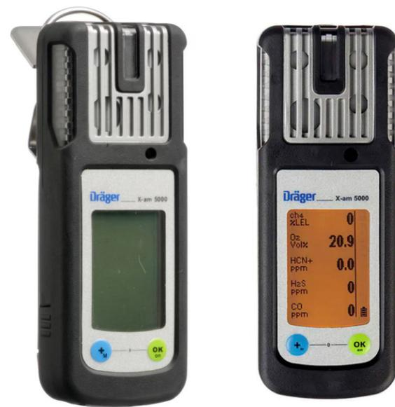
Este detector de 1 a 5 gases mide gases y vapores combustibles con gran fiabilidad, así como oxígeno y concentraciones peligrosas de gases tóxicos, vapores orgánicos, mercaptanos y aminas.
