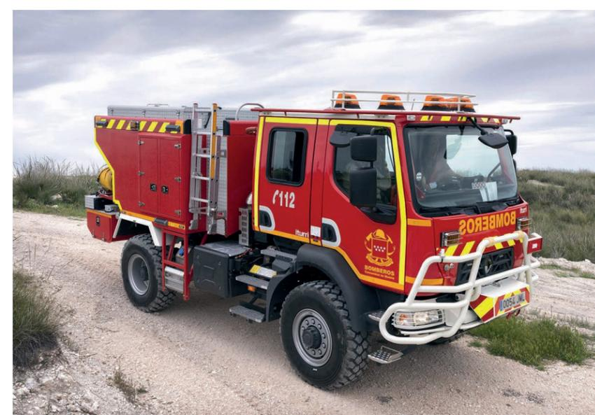
Vehículos robustos dotados de tracción total (mínimo 4x4) adecuados para hacer frente a todo tipo de condiciones adversas en entornos forestales. Diseñados para albergar una gran capacidad para todo tipo de intervenciones.
