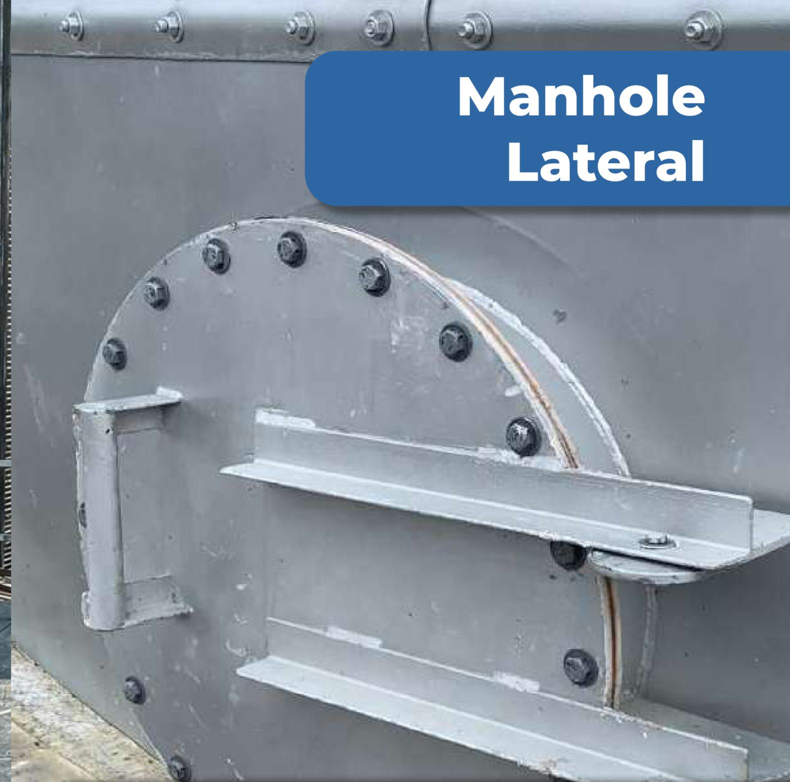
Nuestros depósitos cuentan con un manhole lateral para el ingreso por la parte inferior de personal para el mantenimiento o lavado del equipo. La tapa y el refuerzo del cuello son diseñados para resistir el peso y la presión del contenido del tanque.
